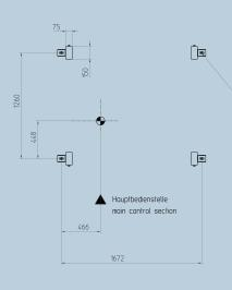
4x Ø18 ₹ 120 für Anker im Boden vorgebohrt siehe Dokumentation Kapitel: Verankerung im Boden
