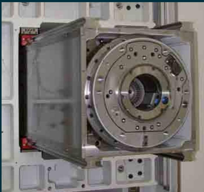
Жесткий ползун с сечением (520x450мм): Система «box-in-box» фиксирует ползун с четырех сторон и обеспечивает максимальную точность и жёсткость
