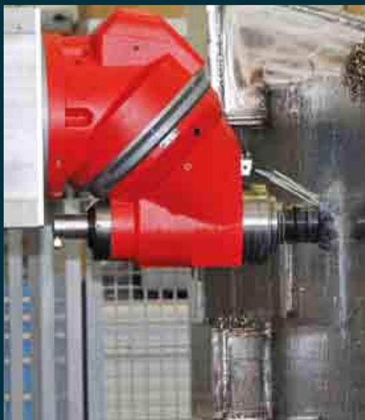
Двухосевая фрезерная головка с автоматическим позиционированием каждую 0,001°, с системой смазки воздух / масло и системой охлаждения СОЖ
