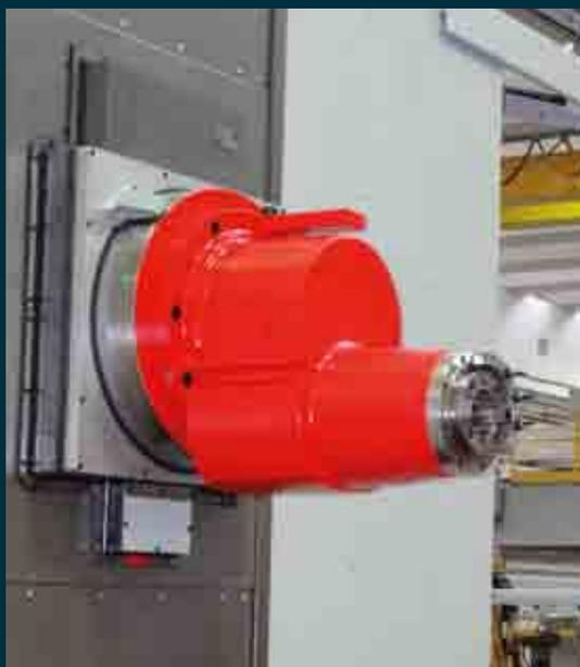
Голова с горизонтальным эксцентричным шпинделем
