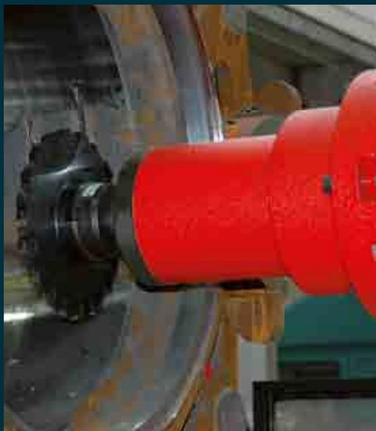
Фрезерная головка с горизонтальным шпинделем
