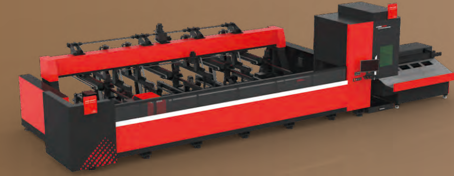
Automatic loading system 全自动上料系统
